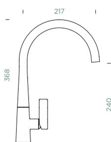
Anschlussschlauch: **450**Schwenkradius: **360**Hebelposition: **rechts**Besonderheit: **Farbvariante lackiert**
