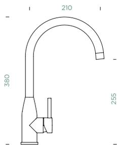
Anschlussschlauch: **450**Schwenkradius: **360**Hebelposition: **rechts**Besonderheiten: **Flüsterperlator, Farbvarianten PVD, galvanisch (PUR)**
