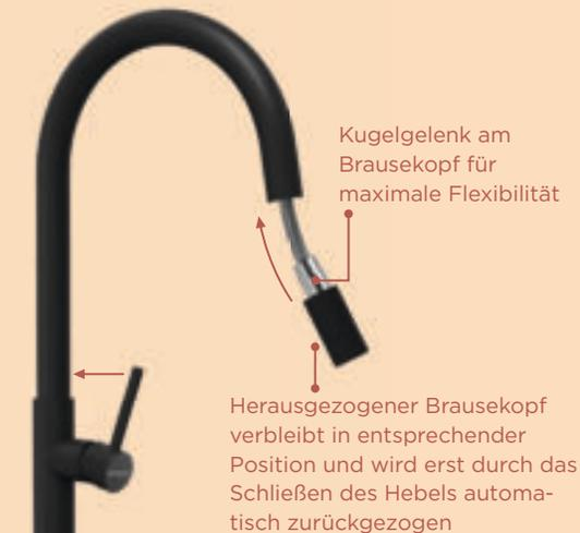
Ausziehbare Armatur mit dem Anschluss einer Festauslauf-Variante. Weder Brauseschlauch noch Gegengewicht im Unterschrank erforderlich!
