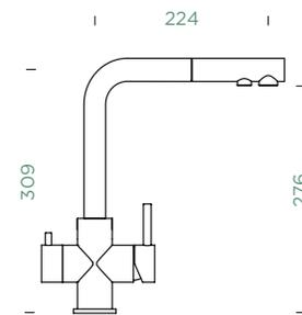
Anschlusschlauch: **450**Schwenkradius: **180**Hebelposition: **rechts**Nutzbare Schlauchlänge: **400**Besonderheiten: **Trinkwasserfunktion, Flüsterperlator, Farbvariante galvanisch (PUR)**
