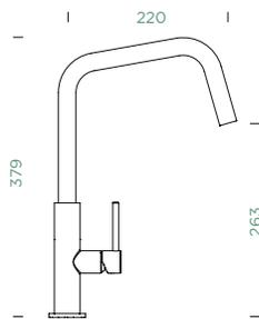
Anschlusschlauch: **500**Schwenkradius: **360**Hebelposition: **rechts**Besonderheiten: **Flüsterperlator, Farbvariante pulverbeschichtet**
