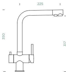
Anschlusschlauch: **450**Schwenkradius: **360**Hebelposition: **rechts**Besonderheiten: **Trinkwasserfunktion, Flüsterperlator, Farbvariante galvanisch (PUR)**
