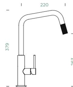
Anschlusschlauch: **500**Schwenkradius: **360**Hebelposition: **rechts**Nutzbare Schlauchlänge: **400**Besonderheiten: **Flüsterperlator, Farbvariante pulverbeschichtet**
