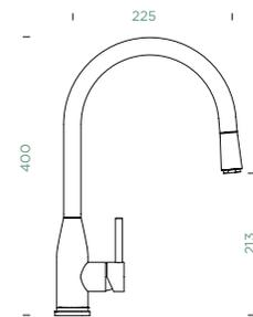
Anschlussschlauch: **450**Schwenkradius: **360**Hebelposition: **rechts**Nutzbare Schlauchlänge: **350**Besonderheiten: **Rückflussverhinderer, Flüsterperlator, Farbvarianten PVD, galvanisch (PUR)**
