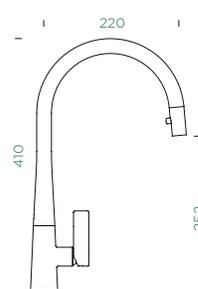
Anschlussschlauch: **450**Schwenkradius: **360**Hebelposition: **rechts**Nutzbare Schlauchlänge: **450**Besonderheiten:
